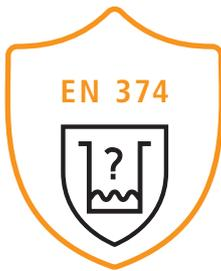
Handschuh ist beständig gegen Chemikalien. Er hat einen Schutzindex von mindestens Schutzlevel 2 bei drei Prüfchemikalien (A - L) gemäss Norm 374.
