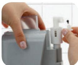
nach Reinigung des Auslaufhahns diesen wieder in die Ausgangsposition zurücksetzen
